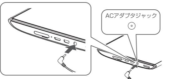
充電が始まると、本製品の前面にあるバッテリー状態ランプがオレンジ点灯します。満充電になるとバッテリー状態ランプが緑点灯に変わります。
