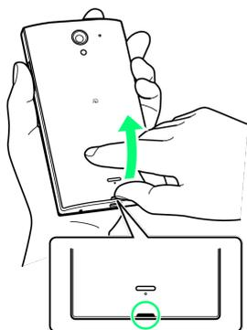
・○の位置（凹部）に指をかけ、電池カバーと本体の間にすきまを作ります。凹部のすきまから本体の外周にそって、指で少しずつ電池カバーを浮かせるようにして取り外します。
