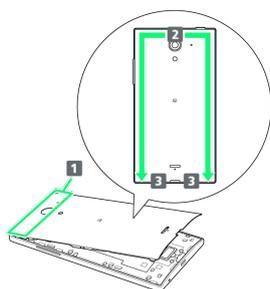
・向きを確認し、カメラの位置を合わせてから、電池カバー上部を本体の電源キー側（**1**）に装着します。電池カバーの周囲〔上部から下部まで（**2**、**3**）〕をしっかりと押さえながら、浮いている箇所がないように、確実に取り付けます。
