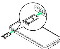
■ USIMカードの取り外しが完了します。
