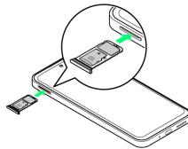
SDカードの取り付けが完了します。
