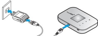
microUSBケーブルのmicroUSBプラグを本機の外部接続端子に、USBプラグをACアダプタに接続してから、ACアダプタのプラグを家庭用ACコンセントに差し込みます。
