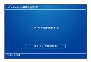
🧭 接続診断が始まります。診断の結果が表示されたら設定完了で す。接続に成功すると、本機ディスプレイの無線LAN機器接続数表 示のカウントが1つ増えます(例: 📅 ⋺ 쪆)。
