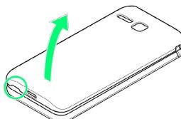
・背面カバーのくぼみに指先をかけて、電池カバーを矢印の方向へゆっくりと持ち上げるようにして取り外してください。
