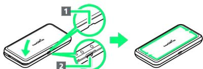
電池パックの取り付けが完了します。
