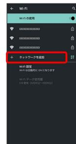
・「ネットワークを追加」の
