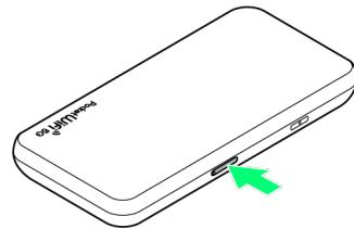
ブルーのLEDが点滅すれば、USIMカードの取り付けが完了します。
