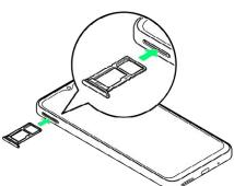
■ USIMカードの取り外しが完了します。
