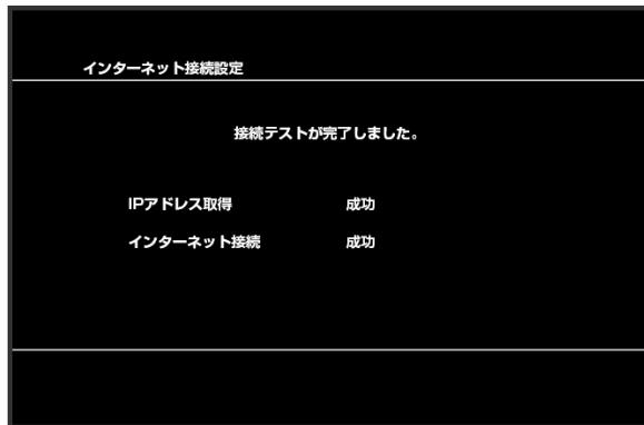
■ 接続テストが始まります。テストの結果が表示されたら設定完了です。接続に成功すると、本機ディスプレイの無線 LAN 機器接続数表示のカウントが 1 つ増えます（例：① → ②）。
