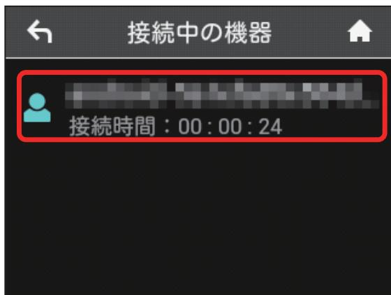
接続中の機器の MAC アドレスまたはデバイス名と、本機と無線 LAN 接続している接続時間が表示されます。
