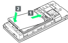
・電池パックと本機の金属端子が合うように **1** の方向に差し込めるから、**2** の方向にはめ込みます。
