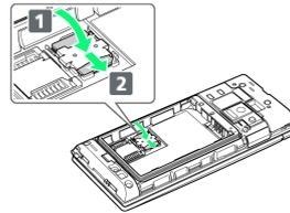
・USIMカードスロットカバーを **1** の方向に倒し、指の腹で **2** の方向にカチッと音がするまで動かしてロックします。
