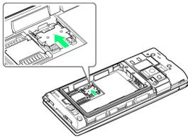
・USIMカードスロットカバーを指の腹で押しながら、矢印の方向にカチッと音がするまで動かしてロックを解除します。
