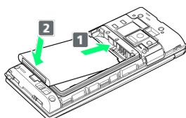
・電池パックと本機の金属端子が合うように **1** の方向に差し込んでから、**2** の方向にはめ込みます。
