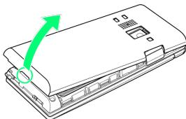
・電池カバーのくぼみに指先をかけて、矢印の方向へゆっくりと持ち上げるようにして取り外してください。
