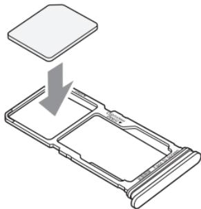
④ SIMカード／SDカードトレイの挿入口に、SIMカード／SDカードトレイをまっすぐに差し込む
