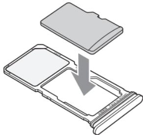
④ SIMカード／SDカードトレイの挿入口に、SIMカード／SDカードトレイをまっすぐに差し込む
